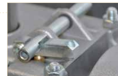
Sblocco esterno anche tramite cordino metallico
