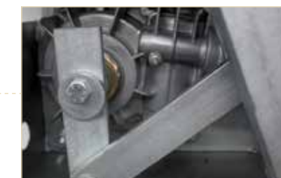
Motore di facile manutenzione grazie ai doppi ingrassatori, sia sulla cassa che sul motoriduttore
