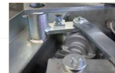
Finecorsa con regolazioni di alta precisione
