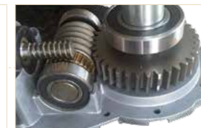
Ingranaggi completamente metallici
