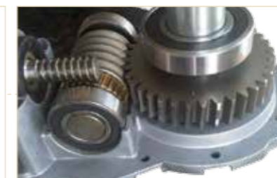
Engrenages complètement métalliques
