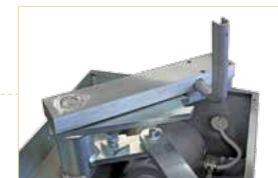
Déblocage extérieur et inférieur, avec un levier à main
