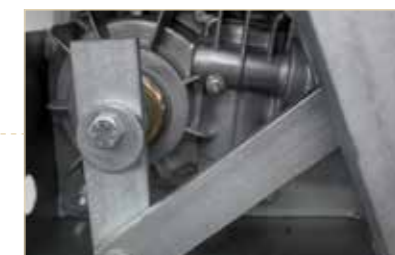
Entretien du moteur facile grâce aux 2 graisseurs
