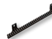
CREM-P Cremagliera M4 in nylon L = 1000 mm per cancelli fino a 800 kg
